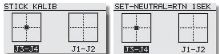
Stellen sie nun den Steuerknüppel in die angezeigte Neutralposition. Nun zur Bestätigung die „**RTN**“ Taste für ca. 1 sek. gedrückt halten, die Übernahme wird mit einem Piepston signalisiert. Der Neutralpunkt ist nun übernommen. Die Einstellung für den Endpunkt rechts unten beginnt automatisch.
