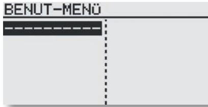
Um das Benutzer Menü anzupassen, muß die „RTN“ Taste betätigt werden. Danach öffnet sich die „MENÜ AUSWAHL“ aus dem die verschiedenen Menüs mit Hilfe des „Cap Touch Feldes“ und der „RTN“ Taste ausgewählt werden können.
