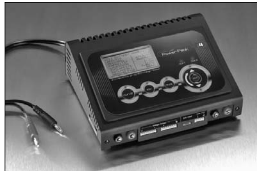
Power Peak I4 EQ-BID No. 8507 Intelligente Hochleistungs-Lade-Entladestation der 4. Generation mit komfortablem Akkumanagement für NC-, NiMH-, Blei-, LiFe, Lilo, LiPo-Akkus, mit integriertem Equalizer und CAP-Touch Bedienungssystem. NC - Akkus: 1...30 Zellen, NiMH - Akkus: 1...30 Zellen, Blei - Akkus: 1...12 Zellen, Lithium - Akkus: 1...12 Zellen Ladestrom: 10 A (max. 210W) Entladestrom: bis 5A (max.50W)
