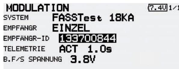
**• LINKING:** Mit der „LINKING“ Funktion werden Empfänger und Sender miteinander verbunden, um Steuersignale und Telemetriedaten zu empfangen.
