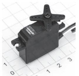
HV-S.BUS-Variante des bewährten Digitalservos S3150. Mit dem enormen Kraftmoment von 45 Ncm bei nur 10,8 mm ‚Dicke‘. Dieses robuste Flächenservo besitzt ein 5-stufiges Getriebe mit 4 Metallzahnradern, wobei 2 Kugellager das Abtriebszahnrad hervorragend gegen Radialkräfte abstützen. Weiter Spannungsbereich von 6...7,4 Volt.
