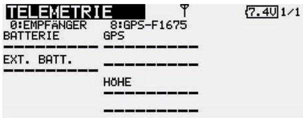
Die beiden Spannungsanzeigen „**BATTERIE**“ und „**EXT.-BATT.**“ sowie die Balkenanzeige der Reichweite sind Sensor-Grundfunktionen des Empfängers und benötigen keinen separaten Sensor.
