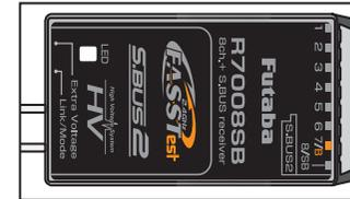
Der Empfänger R7008SB besitzt verschiedene Ausgänge zum Anschluss unterschiedlicher Servotypen, S.BUS-Geräten sowie Telemetrie-Sensoren.
