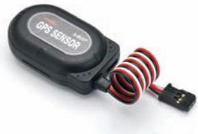
Multifunktionaler GPS-Vario-Höhen-Distanz-Positions-Sensor für das FASSTest®-Telemetrie-System.
