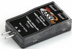
Präzisions-Variometer, mit Höhen und Variometer-Messung über 2 getrennte Druck-Sensoren.
