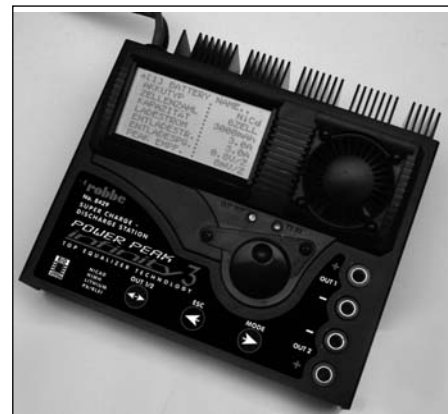
Power Peak Infinity 3 No. 8429 Die intelligente und ultimative Heim - Ladestation mit komfortablem Akkumanagement, zum Laden und Entladen von NC-, NiMH-, Blei und Lithium-Akkus. Zellenzahl NC - Akkus: 1...30 Zellen, NiMH - Akkus: 1...30 Zellen Blei - Akkus: 1...6 Zellen Lithium - Akkus: 1...12 Zellen Lade- Entladestrom 0,1..10 A
