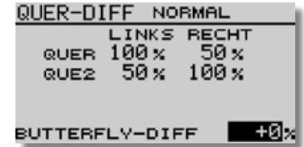
Damit auch bei hochgestellten Querrudern genügend Weg für die Querrudersteuerung zur Verfügung steht, kann für die Butterfly-Funktion eine kleinere Querruder-Differenzierung eingestellt werden. Dadurch vergrößert sich der Weg des nach unten wirkenden Querruders.
