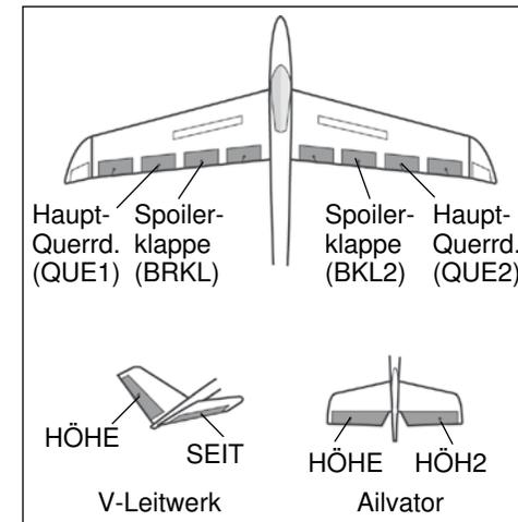
In diesem Menü können die Vorgaben für einen Mischer eingestellt werden, mit dem die gesamte Fläche verwölbt werden kann, um den Auftrieb zu maximieren. Je nach Größe und Einstellung des Ausschlags, sind die Funktionen Wölb, Brems,
