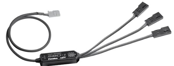
Der S-BUS PWM Adapter No.F1695, bietet die Möglichkeit das neue S-BUS-System auch bei bestehenden Modellen bzw. mit vorhandenen Servos einzusetzen. Adapter zum Anschluss von 3 Standard-Servos an den S-BUS. Wandelt das Signal für jeden Ausgang separat von S-BUS auf PWM um. Den Ausgängen kann eine gleiche oder unterschiedliche Kanalnummern zugeordnet werden. Die Kanalnummern-Zuordnung erfolgt entweder über den PC mit der PC-Link Software oder dem PC-unabhängigen handlichen S-BUS Programmer SBC-1.
