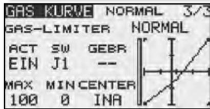
In diesem Menü können für die folgenden Flugzustände Gas-kurven eingestellt werden:
