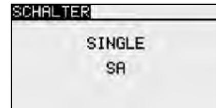
Zum Umschalten der Flugzustände kann zwischen einem einzelnen Schalter (Single) oder einer logischen verknüpften Schalt-Funktion (Logic) zweier Schalter gewählt werden.
