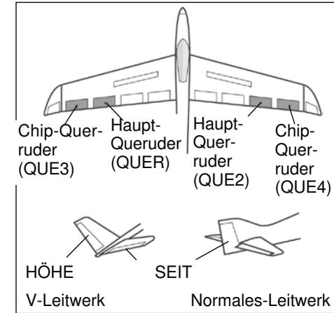
In diesem Menü können die Vorgaben für einen Mischer eingestellt werden, der bei einer Betätigung des Seitenruders das Querruder mit ausschlagen lässt.
