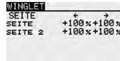
Für beide Ruder der Winglets (“Seite” und “Seite 2”), können getrennt für die Ausschlagsrichtung die Servowege als %-Werte vorgegeben werden. Die Vorgehensweise ist mehrfach beschrieben. Nach der Markierung und Bestätigung des entsprechenden Feldes wird der %-Wert mit dem „CAP TOUCH FELD“ eingestellt und der Vorgang mit “RTN” abgeschlossen.
