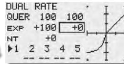
Schalter wählen, zum Umschalten von unterschiedlichen Steuerkurven.
