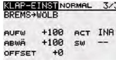
In den ersten Menüs erfolgen praktisch identische Einstellungen. Der Unterschied besteht darin, dass im ersten Display die Vorgaben für die Wölbklappen, im zweiten für die Bremsklappen und im dritten für die Brems- auf Wölbklappen programmiert werden.
