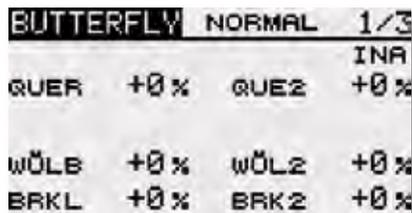
Im oberen Bereich der Ebene (2/3) wird der Zumischanteil für den Höhenruderausgleich eingestellt. 100% Rate entspricht ca. 25° Servoweg. Als Richtwert, schlagen wir 50% = 12,5° Servoweg vor.
