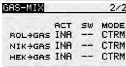
Im ersten Display erfolgt die Einstellung der Mischwerte. Es kann für jeden Mischer, für beide Maximalausschläge des Steuerknüppels jeweils getrennt ein %-Wert (Rate) eingestellt werden. Dazu das Feld markieren, mit dem „CAP TOUCH FELD“ die Einstellung durchführen und die Programmierung mit "RTN" abschließen. Die Einstellung wird als %-Wert im Feld angezeigt.
