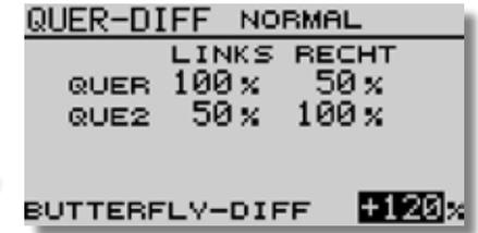
Die Querruder (Kanal 1 und 6) haben nun einen gleichsinnigen Ausschlag nach oben, die Wölbklappen (Kanal 7 und 8) haben einen gleichsinnigen Ausschlag nach unten.
