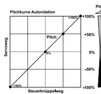
Beispiel einer Kurve für den Flugzustand Autorotation'. Bei 'HOLD'-wird nur ein unterer Gaswert eingestellt der den Motor abschaltet oder in Leerlaufposition bringt.
