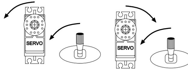
Bei einem Helimodell sollte man genau überlegen ob und welche F/S Position für Gas eingestellt wird. Eine Einstellung von 80 % Gas scheint sinnvoll um den Heli am Hoovern zu halten. Allerdings besteht die Gefahr, dass ein E-Heli, wenn man versehentlich den Sender vor dem Empfänger ausschaltet, selbstständig abhebt. Eine Einstellung von ca. 20% verhindert ein „Wegfliegen“ bei Störungen, jedoch stürzt der Heli ab.
