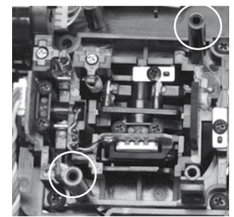
Steuerknüppelplatte links anschrauben.
