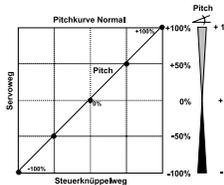
Beispiel einer Pitchkurve für den Flugzustand 'NORMAL'. Programmieren Sie die Kurve so, dass die Motordrehzahl über den gesamten Einstellbereich möglichst konstant bleibt.
