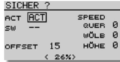
Geber in die gewünschte Position bringen, der entsprechende Wert wird in der untersten Zeile angezeigt. Z.B.: <100%>
