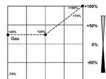
Beispiel einer Kurve für den Flugzustand 'Gasvorwahl 2'. Für den Rundflug wurden die Werte optimiert, damit der Motor für jede Pitchanstellung die richtige Drehzahl behält.
