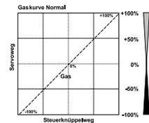
Beispiel einer Gaskurve für den Flugzustand 'NORMAL'. Programmieren Sie die Kurve so, dass die Motordrehzahl über den gesamten Einstellbereich möglichst konstant bleibt.
