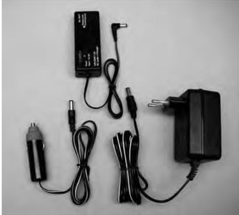
Der im Lieferumfang enthaltene RC-Lader eignet sich zum Laden von 7,4 V Lithium Akkus und besitzt eine spannungsge- steuerte Abschaltautomatik (8,4 Volt). Der Ladestrom beträgt ca. 2 A.
