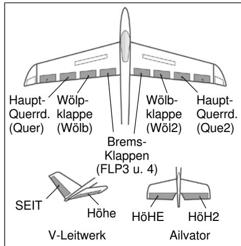
In diesem Menü können die Vorgaben für einen Mischer programmiert werden, mit dem eine sehr hohe Bremswirkung des Modells durch gleichsinnige Ausschläge der Querruder nach oben und der Wölb-Bremsklappen nach unten erzielt wird. Für die Landung von
