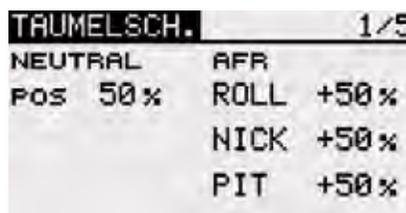
Diese Funktion steht nicht beim Taumelschleibentyp H-1 zur Verfügung, da die Pitch-Funktion nicht gemischt wird.
