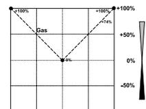
Beispiel einer Kurve für den Flugzustand 'Gasvorwahl 3'. Basiskurve ist eine lineare Kurvenform. Für den Kunstflug wurden die Werte optimiert, damit der Motor für jede Pitchanstellung die richtige Drehzahl behält.
