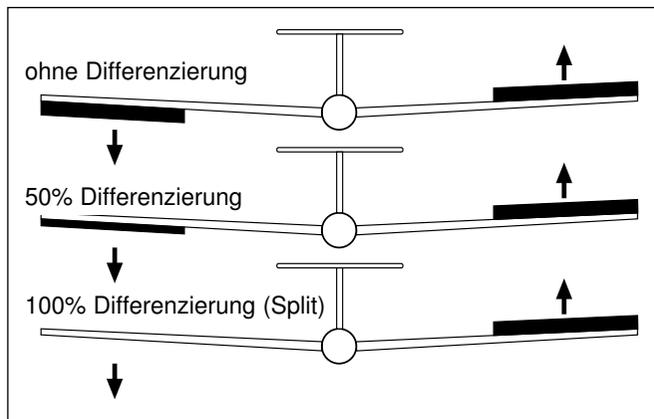
Eine Querruder-Differenzierung bewirkt, dass die nach unten ausschlagende Klappe einen kleineren Ausschlag hat, als die nach oben ausschlagende Klappe, so dass sich an beiden Flächenhälften der gleiche Widerstand ergibt. Dadurch entsteht kein negatives Wenderollmoment.
