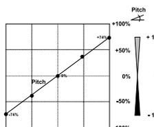
Beispiel einer Kurve für den Flugzustand 'Gasvorwahl 3'. Basiskurve ist eine lineare Kurvenform. Für den Kunstflug wurden die Werte optimiert, damit der Motor für jede Pitchanstellung die richtige Drehzahl behält.
