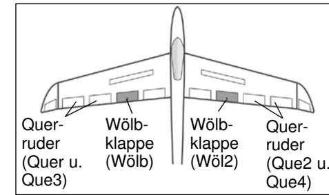
In diesem Menü können die Vorgaben für einen Mischer eingestellt werden, der bei einer Betätigung der Querruder die Wölbklappen gleichsinnig zu den Querrudern ausschlagen lässt. Mit diesem Mischer erreicht man, dass sich die Rollgeschwindigkeit verbessert, weil außer den Querrudern auch die Wölbklappen ausschlagen. Gleichzeitig verringert sich der induzierte Widerstand der Fläche beim Kurvenflug.
