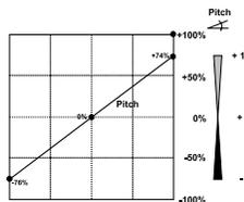
Beispiel einer Kurve für den Flugzustand 'Gasvorwahl 2'. Für den Rundflug wurden die Werte optimiert, damit der Motor für jede Pitchanstellung die richtige Drehzahl behält.
