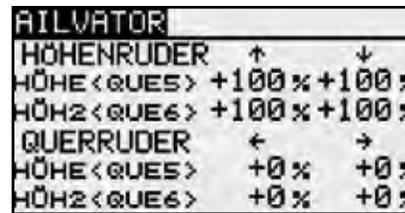
Für beide Ruderklappen eines Höhenleitwerks können getrennt für die Höhen- und Querruderfunktion sowie für die Ausschlagsrichtung die Servowege als %-Wert vorgegeben werden. Die Vorgehensweise ist mehrfach beschrieben. Nach der Markierung und Bestätigung des entsprechenden Feldes wird der %-Wert mit dem „CAP TOUCH FELD“ eingestellt und der Vorgang mit “RTN” abgeschlossen.
