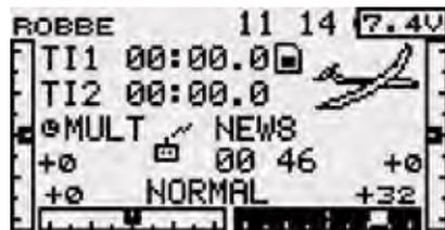
Um die Anzeige auf „0“ zu setzen, wurde die Trimmwertdifferenz im Sender zwischengespeichert. Dadurch lässt sich mit einem Blick auf das Display prüfen, ob alle Trimmungen auf „0“ stehen, bzw, ob man weitere Trimmverstellungen vorgenommen hat.
