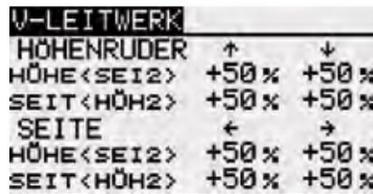
Für beide Ruderklappen eines V-Leitwerks können getrennt für die Höhen- und Seitenruderrfunktion sowie für die Ausschlagsrichtung die Servowege als %-Wert vorgegeben werden. Die Vorgehensweise ist mehrfach beschrieben. Nach der Markierung und Bestätigung des entsprechenden Feldes wird der %-Wert mit dem „CAP TOUCH FELD“ eingestellt und der Vorgang mit “RTN” abgeschlossen.
