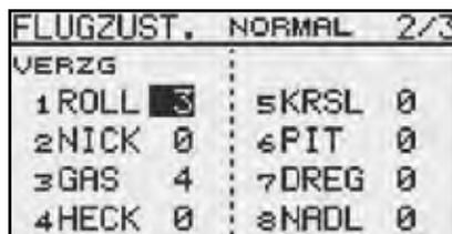
Benutzen Sie das „CAP TOUCH FELD“ und markieren Sie in der 'VERZG'-Spalte den Kanal, für den Sie die Verzögerungszeit verändern möchten. Die Einstellung erfolgt durch eine Drehbewegung am „CAP TOUCH FELD“. Der Einstellbereich liegt zwischen 0 und 27 Schritten. Die Voreinstellung ist jeweils auf '0' gesetzt, d.h. es ist keine Verzögerungszeit programmiert.
