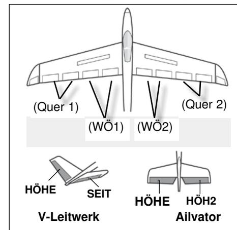
Beim Ausfahren der Wölbklappen die als Landeklappen fungieren, wird es bei vielen Modellen zu einer Lastigkeitsänderung um die Querachse kommen.
