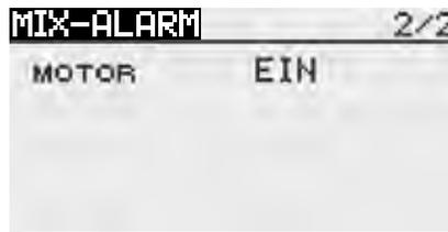
Im Auslieferungszustand sind alle Mix-Alarme auf „EIN“ gestellt. Diese können aber auch, je nach Bedarf, ausgeschaltet werden. Um die Warnmeldung zu beheben, entsprechenden Geber der den Mischer einschaltet, auf „AUS“ stellen, oder Sender ohne HF- Abstrahlung einschalten.
