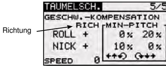
Im Taumelscheiben-Einstellungs-Menü (5/5) kann auch der 'Geschwindigkeitsausgleich' (SPEED) durchgeführt werden. Bringen Sie dazu den Gassteuerknüppel in die Neutralposition. Anschließend bewegen Sie den Nick-Knüppel möglichst schnell. Stellen Sie die Geschwindigkeits-Vorgabe als %-Wert so ein, dass sich dabei kein Ausschlag der Pitch-Funktion ergibt.
