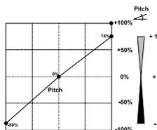
Beispiel einer Kurve für den Flugzustand 'Gasvorwahl 1'. Für den Schwebeflug wurden die Werte optimiert, damit der Motor für jede Pitchanstellung die richtige Drehzahl behält.
