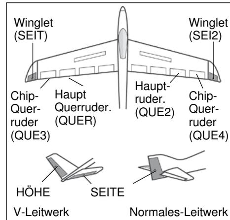
In diesem Menü können die Vorgaben für einen Mischer eingestellt werden, der bei einer Betätigung der Querruder das Seitenruder und wenn vorhanden die Winglets, gleichsinnig mit diesen Rudern ausschlagen lässt.
