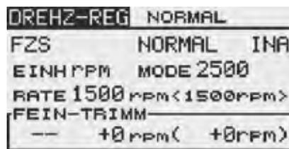
Zur Umstellung das Feld markieren, die Änderung mit dem „CAP TOUCH FELD“ durchführen und den Vorgang mit „RTN“ abschließen. Standard Einstellung sind 1500 rpm. Allerdings kann auch der „2000“ oder „2500“ Mode gewählt werden.
