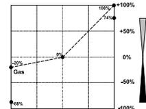
Beispiel einer Kurve für den Flugzustand 'Gasvorwahl 1'. Für den Schwebeflug wurden die Werte optimiert, damit der Motor für jede Pitchanstellung die richtige Drehzahl behält.
