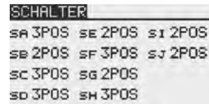
Es gibt verschiedene Ausführungen der Hebelschalter, 2 oder 3 Positionen, tastend oder rastend, auch in Kombination. Auch Drucktaster oder Drehgeber (Potis) können anstelle eines werksseitig eingesetzten Schalter eingebaut werden. Spezielle Schalter mit entsprechender Steckverbindung sind als Option erhältlich. Für evtl. Stickschalter werden die Schalter „SI“ und „SJ“ verwendet.
