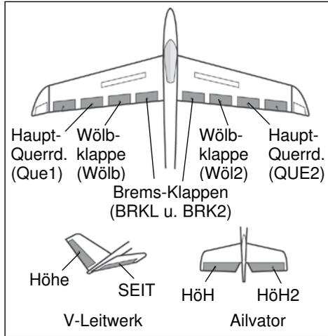
In diesem Menü können die Einstellungen für alle Flächen- und Höhenrudderklappen so eingestellt werden, dass die Geschwindigkeit des Flugzeugs reduziert wird, gleichzeitig aber durch die Flächengeometrie der benötigte hohe Auftrieb für einen Langsamflug erzeugt wird. Dabei schlagen die Ruderklappen der Tragfläche nach unten aus.
