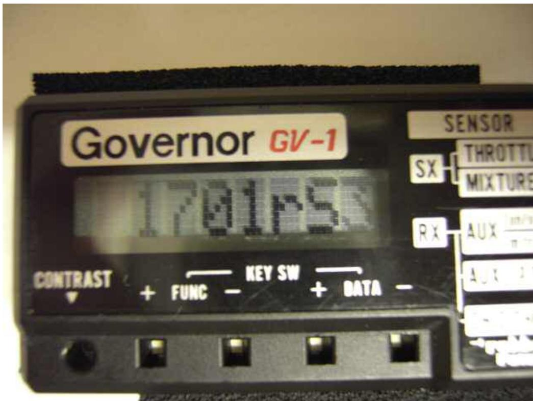
Wird **pro Flugzustand eine Drehzahl** verwendet dann nur **Status auf EIN** und **Drehzahl bzw. Aus** eingeben (Aus ist unter 1000rpm)
