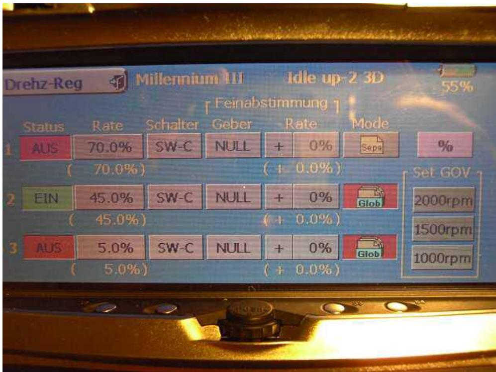
GvOf 85 %-> ab 85% des Gaskanales wird der GV abgeschalten.
