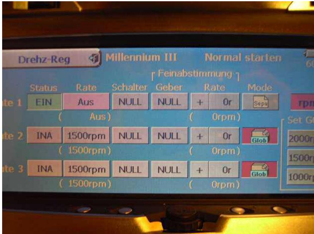
Sollen pro Flugzustand mehrere Drehzahlen verwendet werden dann müssen diese **aktiviert** und ein **Schalter zugewiesen werden**.
