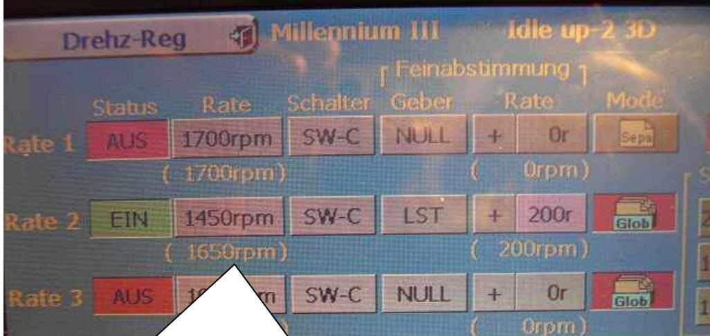
Jetzt ist die **Istdrehzahl** bedingt durch den Geber **+200U/min.**
