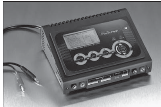
Power Peak® 14 EQ-BID No. 8507 Intelligente Hochleistungs-Lade-Entladestation der 4. Generation mit komfortablem Akkumanagement für NC-, NiMH-, Blei-, LiFe, Lilo, LiPo-Akkus, mit integriertem Equalizer und CAP-Touch Bedienungssystem. NC - Akkus: 1...30 Zellen, NiMH - Akkus: 1...30 Zellen, Blei - Akkus: 1...12 Zellen, Lithium - Akkus: 1...12 Zellen Ladestrom: 10 A (max. 210W) Entladestrom: bis 5A (max.50W)
