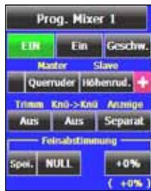
Der Verbindungsmodus kann von 'Aus' (Voreinstellung, keine Anzeige im Feld) auf '+' oder '-' gesetzt werden. Das jeweilige Vorzeichen gibt die Zumischrichtung (gleich- oder gegenläufig) an. Das +/- Zeichen hinter der Slave-Funktion hat eine weitere Funktion. Wird es aktiviert so wird in eine bereits gemischte Slavefunktion auf alle Servos zugemischt. In diesem Beispiel
