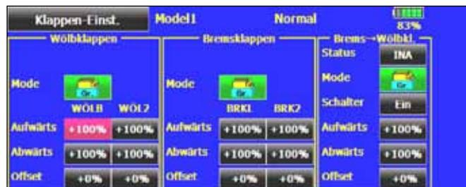
Für jede Klappe und jede Bewegungsrichtung kann individuell der Weg eingestellt werden. Das gleiche gilt für die Offset-Funktion, der Abgleich wird mit den Pfeiltasten als %-Wert eingestellt. Der Einstellbereich für Auf- und Abwärts liegt für beide Klappen zwischen - 120 % und + 120 %, die Voreinstellung beträgt 100 %.
