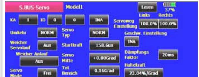
Sobald die Akkuspannung angeschlossen ist, muß die „Lesen“-Taste gedrückt werden. Dadurch werden die Servodaten gelesen und angezeigt.
