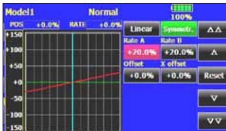
Die Programmierung erfolgt getrennt und individuell für beiden Seiten der Kurve (Rate A und Rate B). Mit den Pfeiltasten am rechten Rand kann die Einstellung der Kurve durchgeführt werden, sobald eines der Einstellfelder markiert worden ist.
