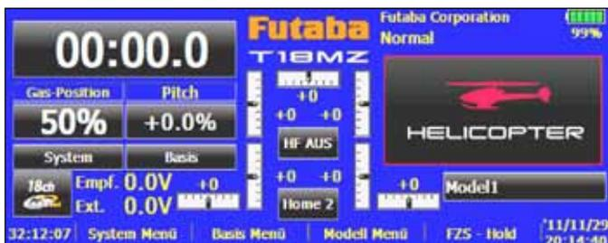
Um zu den Einstellungen für die Pitch-Kurve zu gelangen, markieren Sie diese Option im Modell-Menü beim Modell Typ 'Helicopter'.
