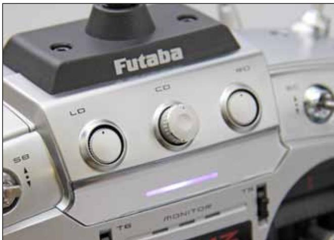
Der mittlere Drehgeber CD ist ein digitaler Trimmgeber ohne Anschlag, zusätzlich ist er noch mit einer Drucktastenfunktion versehen (CD-SW).
