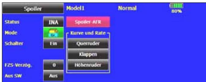
Auch diese Mischfunktion muss zunächst in der Status Zeile aktiviert werden. Das Feld markieren, im Feld wird danach statt 'INA' (inaktiv), je nach Schalterstellung 'EIN' bzw. 'AUS' angezeigt.
