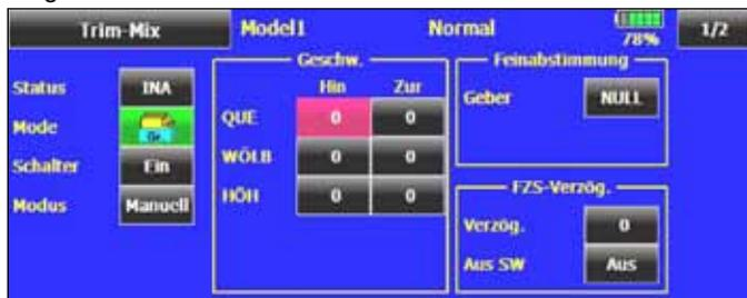
Die Trim Mix Funktion muss zunächst in der Status Zeile aktiviert werden. Das Feld markieren, danach wird statt 'INA' (inaktiv), je nach Schalterstellung 'EIN' bzw. 'AUS' angezeigt.
