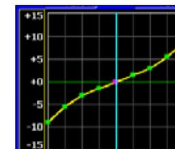
Beispiel einer Kurve für den Flugzustand 'Autorotation'. Basiskurve ist eine lineare Kurvenform. Bei einer 'HOLD'-Kurve wird der Motor abgeschaltet oder in Leerlaufposition gebracht, siehe Menü 'Autorotation' (Kap. 15.8).
