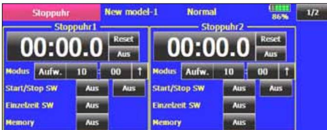
Von diesem Hauptmenü der Timer Funktion aus, kann bereits die gewünschte Stoppuhr, durch Antippen des Anzeige-Feldes gestartet bzw. gestoppt werden. Durch Betätigung der 'Reset'-Taste kann die Anzeige auch zurück gesetzt werden.
