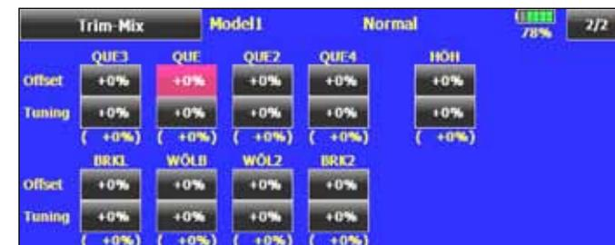
Für jedes Ruder, bzw. für jede Klappe kann jeweils ein Offset-Wert vorgegeben, indem das entsprechende Feld markiert und mit den Pfeiltasten die Einstellung vorgenommen wird. Der Einstellbereich liegt jeweils zwischen + 250 % und - 250 %, die Voreinstellung liegt bei 0 %. Durch Betätigung der 'Reset'-Taste wird sie wieder wirksam.
