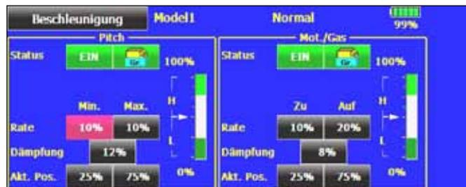
Stellen Sie sicher, dass bei Verwendung dieser Funktion die Gas- und Pitchanlenkungen ausreichend Bewegungsfreiheit haben und nicht mechanisch begrenzt werden.
