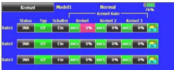
Das Menü hat drei identische Ebenen für die Einstellung von drei verschiedenen Empfindlichkeiten (Rate 1-3) Ausserdem kann die Einstellung auch für die Kreisel 2 und 3 eingestellt werden. Dadurch ist es möglich, pro Flugzustand drei verschiedene Kreisel oder eine 3-Achs Kreisel Einstellung abzurufen.
