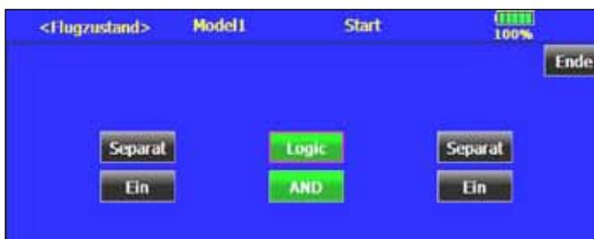
Dabei kann zwischen einem ganz normal wirkenden Schalter (Separat) oder einem Schalter mit einer logischen Funktion (Logic) gewählt werden.
