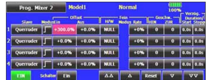
Ein Offset-Mischer bietet auch die Möglichkeit gegen den eigenen Kanal einen festen Wert zu mischen. Wie dargestellt kann dieser Wert bis zu 300 % betragen. Damit kann man es z.B. aus Sicherheitsgründen absolut unterbinden, dass bei einem Elektroflugmodell der Motor anlaufen kann. Auch wenn man versehentlich den Steuerknüppel betätigt. Wenn ein Offset-Mischer programmiert worden ist und der Offset-Wert -300 % beträgt, kann der Knüppel hin und her bewegt werden.
