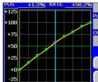
Beispiel einer Kurve für den Flugzustand 'Gasvorwahl 1'. Für den Schwebeflug wurden die Gaswerte optimiert, damit der Motor für jede Pitchanstellung die richtige Drehzahl behält. Für die meisten Einsatzzwecke sind 5 Punkte-Kurven ausreichend.
