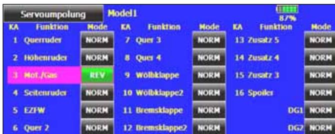
Für alle 18 Kanäle wird die aktuelle Drehrichtung der Servos (NORM oder REV) dargestellt. Die Umschaltung erfolgt durch Aktivierung des entsprechenden Feldes. Der Kanal wird markiert, es erfolgt eine Sicherheitsabfrage, wie im folgenden Display dargestellt.
