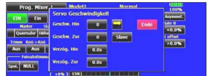
In diesem Menü kann sowohl die **Geschwindigkeit** für den Hin- als auch für den Rücklauf programmiert werden. Nach dem Markieren eines der 'Geschwindigkeits'-Felder, erscheinen am rechten Rand die Einstellertasten.
