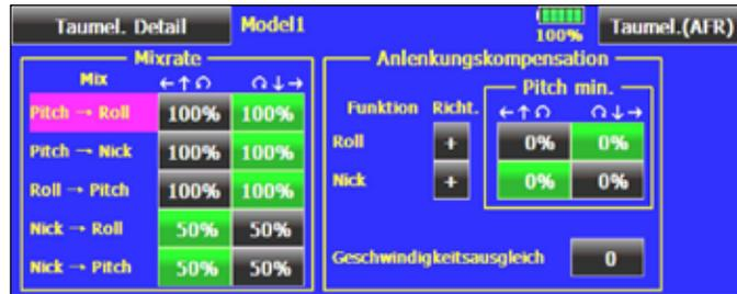
Im Basis Menü markieren Sie die Option ‚Taumelscheibe‘, danach markieren Sie in der rechten oberen Ecke die Schaltfläche ‚**Taumel. Detail**‘.
