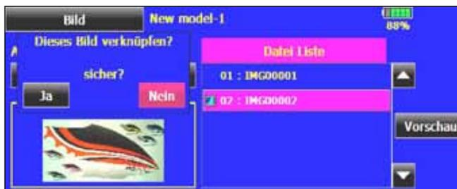
Wird der Modellspeicher auf eine SD-Karte oder USB-Stick kopiert, um in einem anderen Sender eingesetzt zu werden, so muss auch das entsprechende Bild mitkopiert werden.
