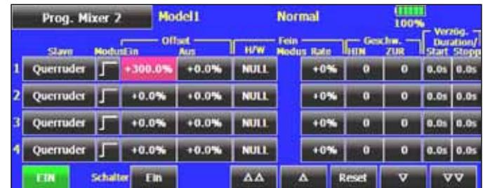
Zuerst muss der bzw. die 'Slave'-Kanal/Kanäle bestimmt werden, zu dem bzw. denen ein fester Wert hinzugemischt werden soll. Dabei können bis zu vier Funktionen bedient werden.
