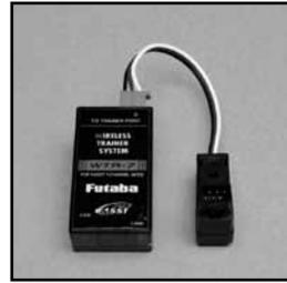
Das WTR 7 ist ein Wireless Trainer System für 2,4 GHz FASST Anlagen, welches das bisherige Lehrerschülerkabel durch eine Funkstrecke ersetzt. Der Empfänger wird über die Trainer-Buchse am Lehrersender angeschlossen, danach der 2,4 GHz FASST Schülersender mit dem WTR7 verlinkt (angebunden).
