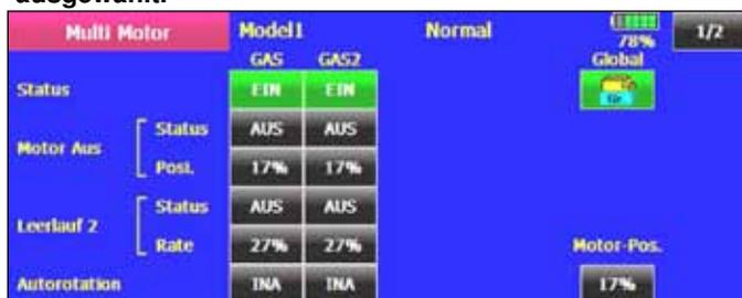
Zuerst muss für jeden Gaskanal (GAS; GAS2 usw.) in der Zeile Status eine Aktivierung für die gesamte Funktion durchgeführt werden. Die Anzeige wechselt dabei von 'INH' (inaktiv) auf 'EIN'.
