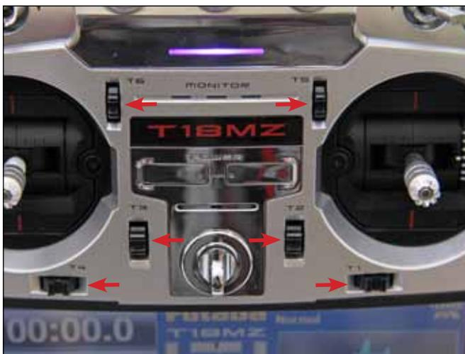
Der Sender besitzt sechs Digitale Trimm-Taster (T1...T6). Bei jeder Betätigung wird der Trimmwert um die voreingestellte Schrittweite verändert. Wird die Trimm-Taste gehalten um eine größere Verstellung des Trimmwertes zu erreichen so erfolgt eine automatische Beschleunigung der Verstellung.
