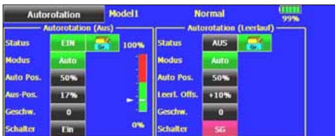
In diesem Display ist sowohl für den Bereich 'Motor-Aus', als auch für 'Leerlauf' eine Automatik-Position programmiert.
