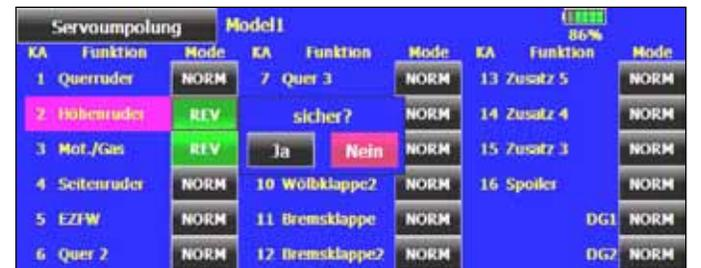
Wird auf den Button 'JA' gedrückt ist die Laufrichtungsänderung aktiviert und der Vorgang abgeschlossen.
