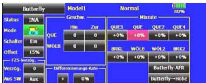
Den Butterfly Mischer Zeile „Status“ aktivieren. Der Mischer ist nun aktiv, solange kein Deaktivierungsschalter vergeben ist. Bei der Modellerstellung, wird automatisch der Gassteuerknüppel als Geber voreingestellt.
