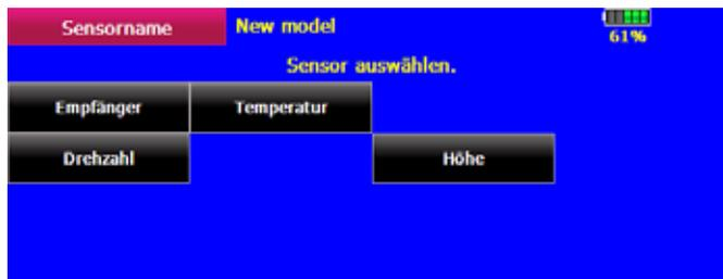
Um gleiche Sensortypen besser unterscheiden zu können, besteht die Möglichkeit die Sensoren unterschiedlich zu benennen.
