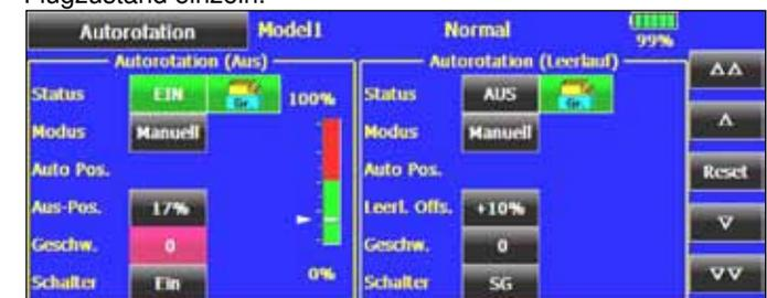
Es ist zwingend erforderlich im Menü FLUGZUSTAND auch diesen für die Autorotation zu aktivieren, da dort die Rücklaufgeschwindigkeit von der Autorotationsposition z. B. in den Flugzustand "Kunstflug" festgelegt wird.
