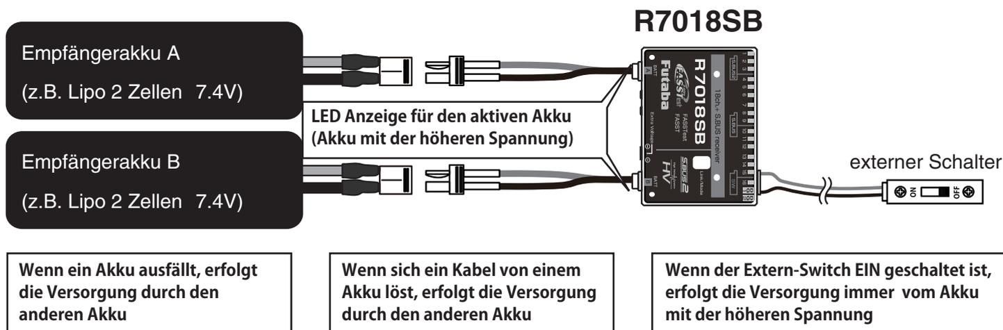
Der Empfänger besitzt intern einen elektronischen FET-Sicherheits-Schalter. Dieser wird mit dem Extern-Schalter geschaltet. Strom fließt über den Extern-Schalter nicht. Andere als der beiliegende Schaltertyp können nicht benutzt werden. Bei längerer Nicht-Benutzung des Empfängers sollten die Akkus am Empfänger abgesteckt werden.
