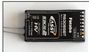
Der Empfänger R6308SB besitzt verschiedene Ausgänge zum An- schluss unterschiedlicher Servoty- pen, S.BUS-Geräten sowie Teleme- trie-Sensoren.
