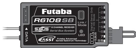
8 / 18 - Kanal-FASST-Empfänger 2,4 GHz mit voller Reichweite, schmal und leicht für Modelle mit engen Rumpfen. Mit seriellem Bus (S-BUS) - System für bis zu 18 Kanäle und somit auch perfekt für Großflugmodelle. An den Ausgängen 1...8 sind 8 herkömmliche Analog- oder Digitalservos anschließbar. Der R 6108SB Empfänger besitzt einen Umschalter für Digital- und Anlogservos.
