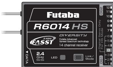
Der R 6014HS Empfänger besitzt einem Umschalter für Digital und Analogservos. An den Ausgängen 1-6 kann dadurch die Impulsausgabe für Digitalservos noch schneller erfolgen, was zu einer noch kürzeren Reaktionszeit führt. Mit 2-Antennen-Diversity System. Über einen Brückenstecker können die Kanäle 11+12 für den Betrieb mit dem Multiprop-Decoder MPDX1 umgestellt, auf jeweils 8 Multipropkanäle erweitert werden. Die Gesamtkanalzahl beträgt dann 10+16+2 Kanäle.
