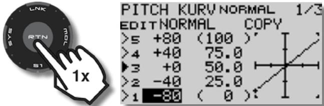
Nun erfolgt die zusätzliche Abflachung im Schwebebereich (auch für Rückenschweben) durch eine Verschiebung der Punkte 4 und 2 in waagerechter Richtung.
