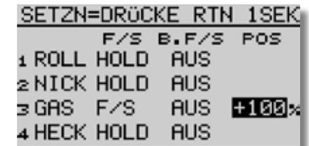
Battery-Fail-Safe warnt den Piloten, wenn der Empfängerakku leer wird.
