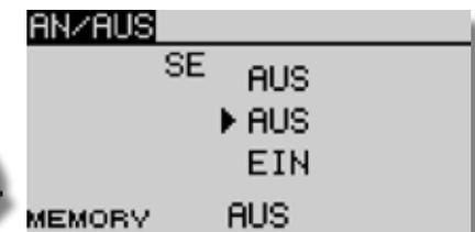
Die Stoppuhr soll stehenbleiben, wenn der Flugzustand Normal eingeschaltet ist und laufen, wenn einer der anderen Flugzustände (Gasvorwahl 1-3) aktiv ist (Motor läuft), damit der Pilot an die Landung erinnert wird, bevor der Flug-Akku leer wird.
