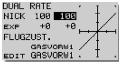
Unterschiedliche Servowege können auch innerhalb eines Flugzustandes über einen oder mehrere Schalter abgerufen werden, z.B. wenn man den optimalen Dual-Rate-, oder Expo-Wert erst noch erfliegen will.
