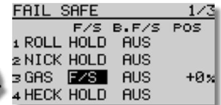
(F/S) Fail-Safe: Hierbei laufen die Servos auf eine, über den Sender vorprogrammierte Position, welche ebenfalls im Empfänger zwischengespeichert wird.
