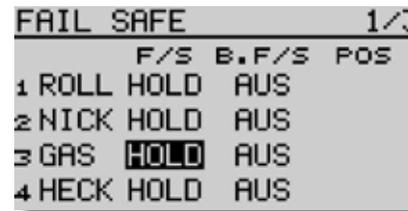
HOLD-Mode: Im Empfänger werden die letzten fehlerfreien Impulse zwischengespeichert und im Falle einer Störung an die Servos weitergegeben. Diese werden so lange beibehalten, bis wieder einwandfreie Signale vom Sender kommen.
