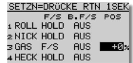
Geber bzw. Schalter für den Motor in die entsprechende Position (AUS) bringen und dann RTN 1 Sekunde lang drücken, um den Wert zu speichern!
